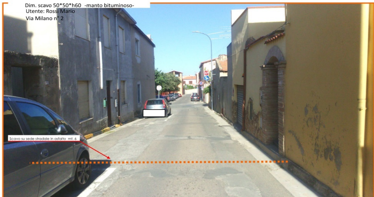
Schema tipo allaccio Idrico/fognario taglio trasversale su strada asfaltata
