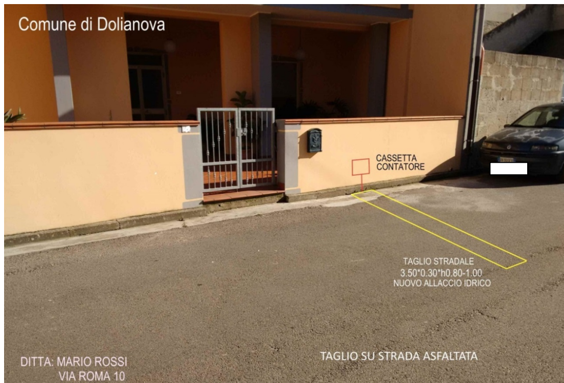
Schema tipo allaccio idrico taglio trasversale su cunetta in cls e strada asfaltata
